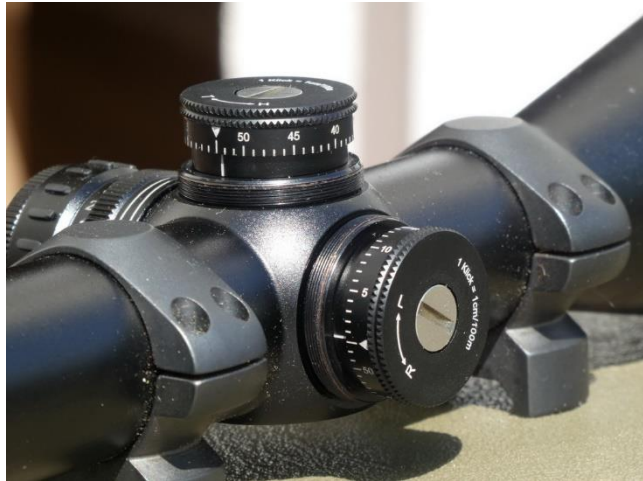
Verstellelemente am Zielfernrohr: Der Obere Turm ist für die Höhen- (H <->T), der rechte Turm für die Seitenverstellung (L <-> R) zuständig. Die Absehenverstellung ist genullt.
