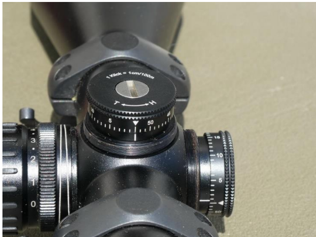
In der Mitte der Verstelltürme befinden sich die Arretierschrauben. Achtung Feinmechanik! Nur leicht anziehen. An den Türmen ist auch der Verstellweg mit 1cm/100m angegeben
